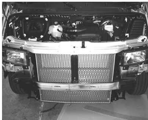
Kühler- und Motorschutz aus Edelstahl-Lochblech
