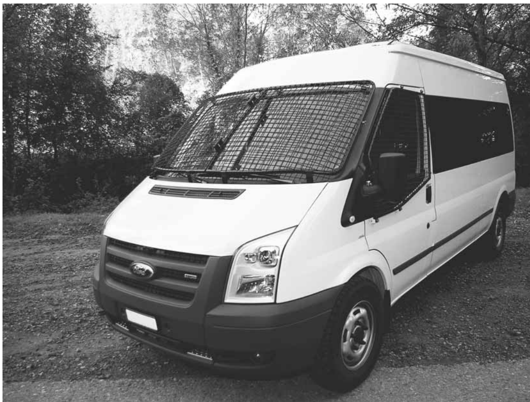
Schutzvergitterung Frontscheibe und Seitenscheiben Fahrerraum
