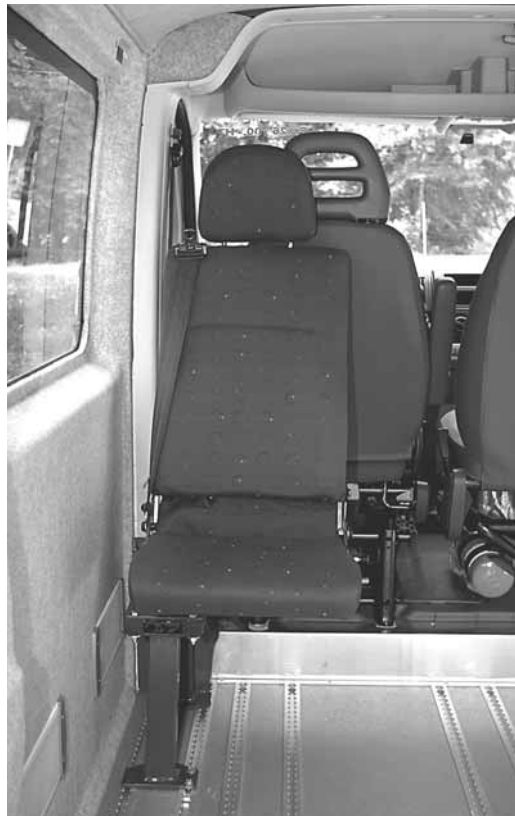
Dreh-Klappsitz mit Schnellverschluss auf der gesamten Laderaumlänge verschiebbar und demontierbar
