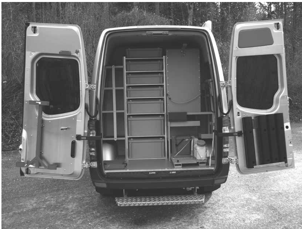
Lagergestell für PVC-Kisten, Auszug für einen Stromgenerator usw. An den Hecktüren Lagerung von Triopanen und Teleskopleiter
